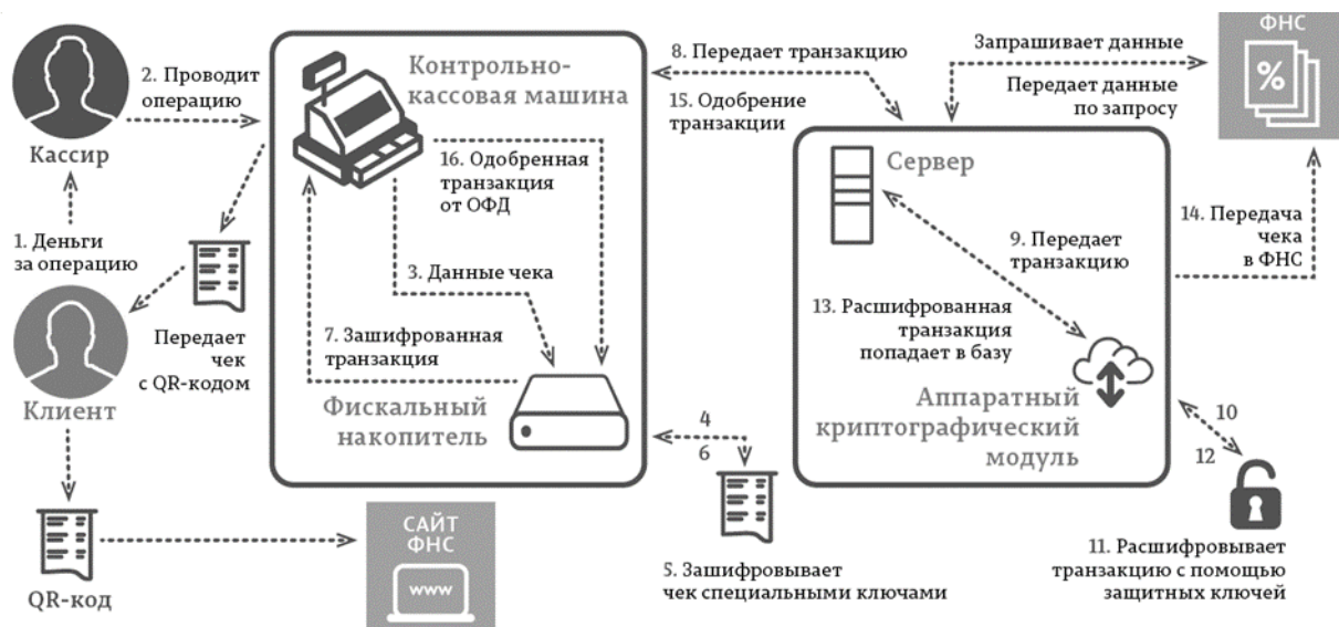
Рисунок 1 – Схема функционирования онлайн-кассы
